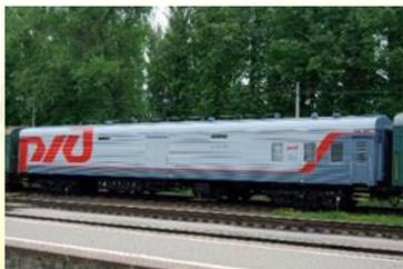
Багажный вагон-используется для перевозки чемоданов, сумок и других вещей пассажиров в поездах.
