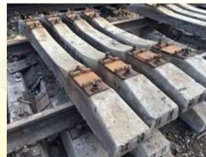
**Шпала – опора для рельсов железнодорожного пути в виде поперечного лежня, укладываемого под оба рельса.**
